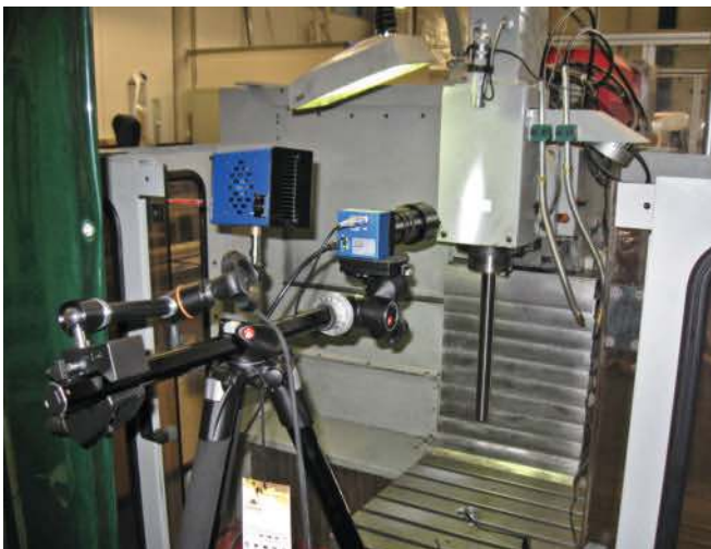
1 Versuchsaufbau, Highspeedkamera und LED-Strahler
